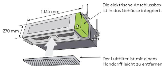
Der Kondensatablauf kann beidseitig erfolgen, wodurch kurze Leitungswege ermöglicht und Installationskosten reduziert werden.
