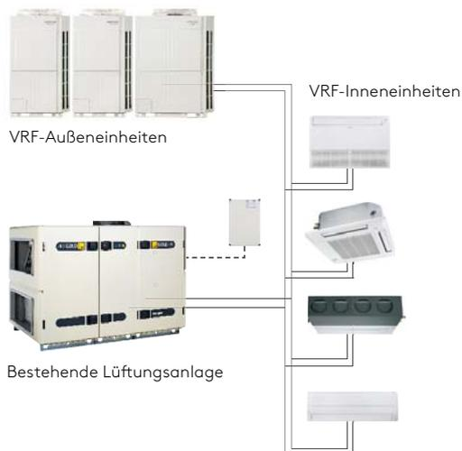
Lüftungsanlage mit INV-Modul
