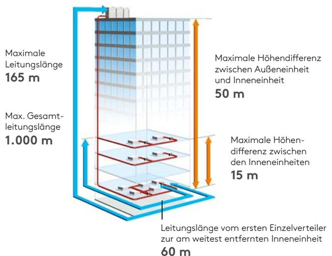
Die Vorteile von VRF-Systemen gegenüber herkömmlichen Multi-Systemen sind vielfältig. Eine hohe Regelprecision, der Komfortgewinn durch eine an den Bedarf angepasste Leistung sowie flexible Systemgestaltungsmöglichkeiten sind nur einige Beispiele.
