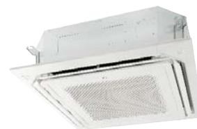
Die Slim 3D-Kassettenmodelle der Serie AUXM schaffen ein individuell an die einzelnen Personen im Raum angepasstes, zugfreies Wohlfühlklima. Zentrale Merkmale sind wie bei der größeren AUXK-Reihe, der 360°-Rundum-Luftauslass und die separat einstellbaren Luftleitlamellen. Ein zusätzliches Plus, z.B. bei niedrigen Zwischendecken, ist die geringe Einbautiefe von 256 mm.
