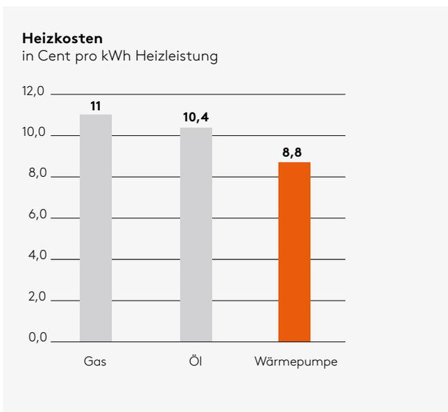
Bild 1: (Gas: 1,10 € pro m<sup>3</sup>, Öl: 1,04 € pro Liter, Strom: 0,37 € pro kW, SCOP 4,2)
