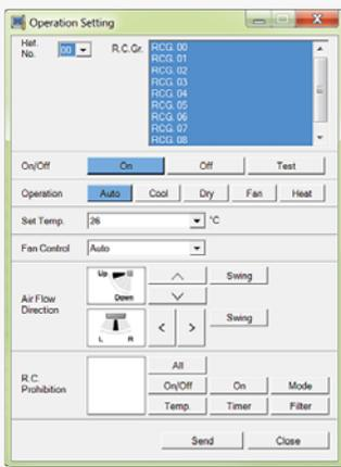
Oberfläche der virtuellen Fernbedienung um einzelne oder alle Inneneinheiten zu steuern.
