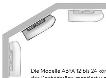
Die Modelle ABYA 12 bis 24 können auch in der Dachschräge montiert werden.
