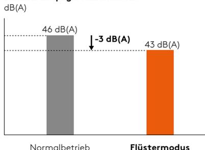
Die Luftzirkulation der Inneneinheit wird stark reduziert, so dass sie kaum mehr hörbar ist. Gleichzeitig fährt die Lüfterleistung an der Außeneinheit herunter, da durch die niedrigen Außentemperaturen in der Nacht nur ein geringer Teil der maximalen Leistung benötigt wird. So können auch Ihre Nachbarn ungestört schlafen.
